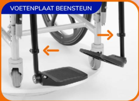
De voetenplaathoogte bij de wegzwankbare beensteunen kan versted worden door met inbussleutel nr.5 de boutjes los te draaien en de voetenplaat te laten zakken.
