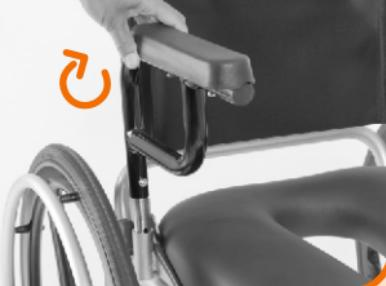
Armlehne nach oben anheben und zur Seite schwenken. Nach dem Zurückschwenken, bitte darauf achten, dass die Armlehne wieder vollständig eingerastet.
