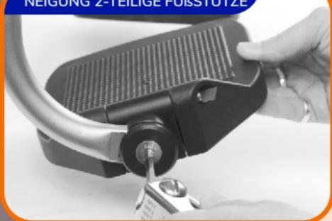
Die zweiteiligen Fußstützen haben die Möglichkeit, angewinkelt zu werden. Verwenden Sie dazu einen Inbusschlüssel Nr. 5
