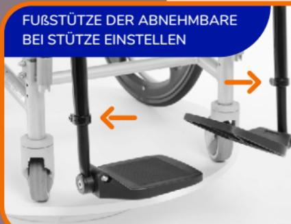
Lösen Sie die Verschraubung mithilfe eines Inbusschlüssels Gr. 5. Stellen Sie die gewünschte Höhe durch herein- oder herausschieben des Rohres ein und befestigen Sie die Fußteile mittels der Schrauben.
