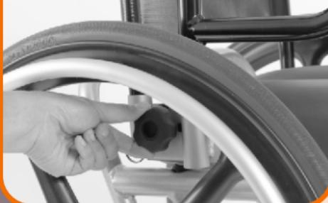
Lösen Sie die Drehknöpfe rechts und links der Lehne, um die Verzahnung freizugeben. Bewegen Sie die Rückenlehne in die gewünschte Position. Schrauben Sie die Drehknöpfe bis zum vollständigen Einrasten der Verzahnung wieder fest.
