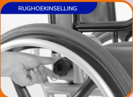
Draai de knoppen links en rechts van de rugleuning los, zodat de kartelschijven vrij kunnen roteren. Stel de rugleuning in de gewenste stand en draai de knoppen links en rechts weer vast. Op deze manier kan ook de rug volledig platgeklapt worden voor vervoer.
