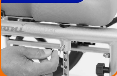
Verwijder de quick release pennen en druk de zitting in de laagste stand. Plaats de quick-release pennen weer terug.
